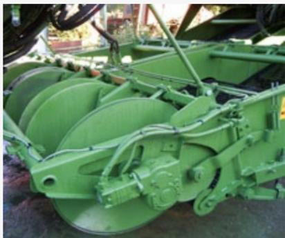
Contrôle de la profondeur de travail de l'effeuilleuse et du bâti arracheur par patins de contrôle, proportionnel à l'avancement.
