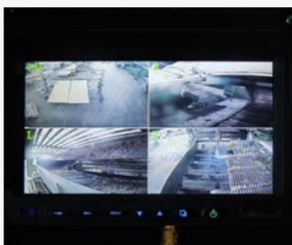
4 caméras infra-rouges pour le contrôle des différentes parties de la machine.
