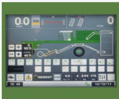
Ordinateur de bord pour la gestion de chaque élément de la machine (réglage des moteurs hydrauliques, contrôle de la direction des roues arrières...) et pour l'affichage des informations (vitesse d'avancement, surface travaillée...).
