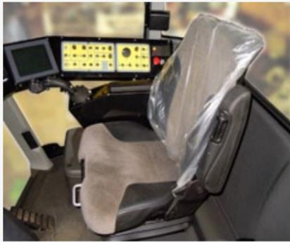
L'ensemble des commandes de l'arracheuse sont regroupées de manière ergonomique sur l'accoudoir droit: réglage des différents organes de la machine, écran de contrôle, ordinateur de bord et levier d'avancement.
